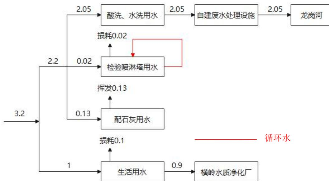
图 2-1 项目扩建前给排水平衡图（单位：m<sup>3</sup>/d）
