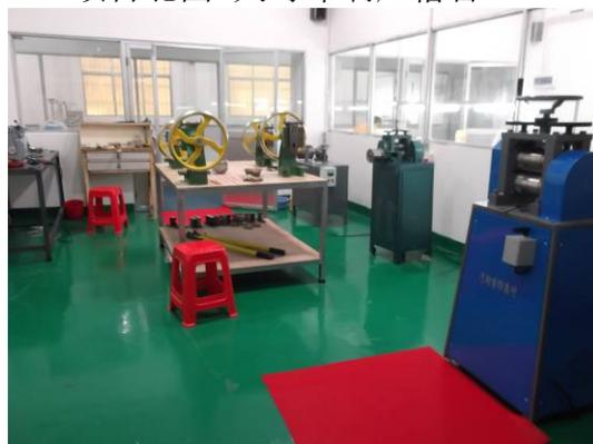
项目拉线机、压片机、压线机、手啤机
